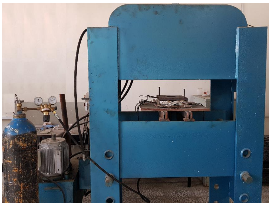
دستگاه پرس هیدرولیکی ۱۰۰ تن مجهز به فرایند آزمایش شکل دهی با گاز
