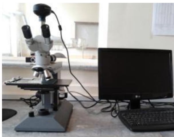
میکروسکوپ نوری مجهز به کامپیوتر و نرم افزار آنالیز سطوح
